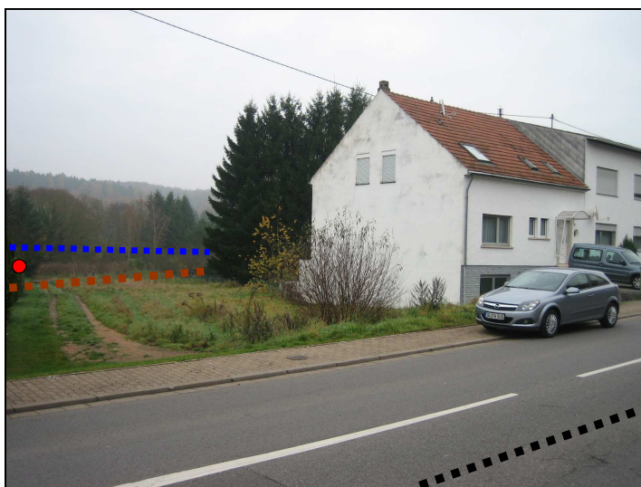
Abb. 17: Blick vom westlichen Rand der Ortsbebauung nach Norden in die Bistau. In der Überherrmer Straße verläuft der bestehende Gemeindekanal (schwarze Linie), an den die talseitigen Anwesen nicht angeschlossen sind. Zur besseren Orientierung sind wiederum die Bist (blaue Linie) und die geplante Führung des Hauptsammlers (braune Linie) eingezeichnet. Am linken Bildrand (roter Punkt) befindet sich hinter den dortigen Nadelgehölzen der Brunnen Differten 7. Rückwärtig der Straße verläuft die Außengrenze der Wasserschutzzone II.
