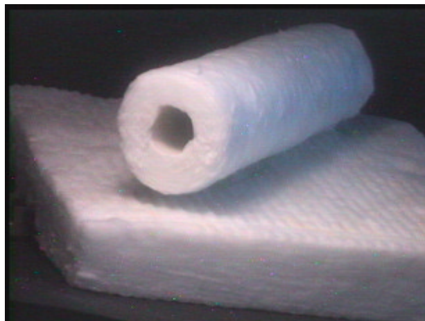
Bild 16: Glasfasermatte und -rohrschele, in Praxisversuchen bei der Fa. Pfeiderer Dämmstofftechnik mit dem Sol-Gel-Bindemittel MTKS 300/30-0,4 (Nomenklatur s. Kap. 4.1.6) unter Produktionsbedingungen hergestellt
