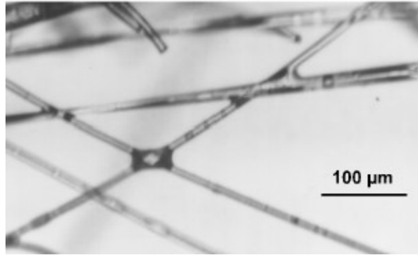
Bild 2: Ausschnitt aus einer mit Phenolharz gebundenen Glasfaser-Dämmmatte der Fa. Pfeleiderer Dämmstofftechnik unter dem Lichtmikroskop
