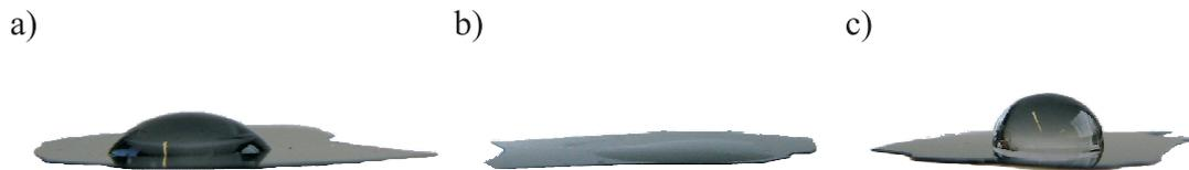
Abbildung 1.5: Aufnahme des Kontaktwinkels von Wasser auf oberflächenmodifiziertem Silizium. a) wie präpariert: der Kontaktwinkel ist  $\approx 50^\circ$ . b) 23h oxidiert in  $H_2O_2$ : die Oberfläche ist hydrophil. c) 23h oxidiert in  $H_2O_2$ , danach silanisiert: der Kontaktwinkel beträgt  $\approx 90^\circ$ .
