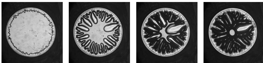
FIGURE 11.6.: L'instabilité de Saffman–Taylor dans une cellule circulaire avec entrefer variable à temps différents. R_0 = 3 mm, b_0 = 50 \mu\text{m} , v_0 = 8 \mu\text{m/s} , \eta = 96 Pa s.
