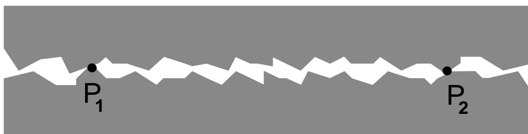
Abbildung 11: Bei realen Objekten existieren aufgrund der Feinstruktur der Materialien keine perfekt ebenen Flächen und keine perfekt geraden Kanten. Unter der Annahme starrer Objekte ist die Realisierung von Flächenkontakten und Linienkontakten durch jeweils wenige Punktkontakte auch physikalisch plausibel.
