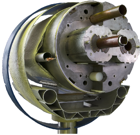
Abbildung 2.1: Ein Dipolmagnet des LHC.
