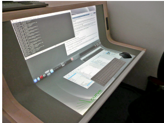
Abbildung 3.25.: Prototyp Curve (Wimmer et al., 2010). Curve wurde nach den ermittelten Kriterien umgesetzt. Es verbindet ein vertikal und horizontal geneigtes Multitouch-Display über eine gekrümmte Fläche zu einer Arbeitseinheit.
