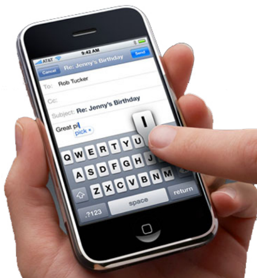
Abbildung 1.3: Occlusion und Fat-Finger bei Multitouch-Eingaben. Durch die direkte Eingabe auf dem Bildschirm werden mehrere Tasten aufgrund der kleinen Größe durch den Finger verdeckt ( Occlusion ), sodass der Benutzer nicht weiß, ob er die richtige Taste erwischt hat ( Fat-Finger ).
