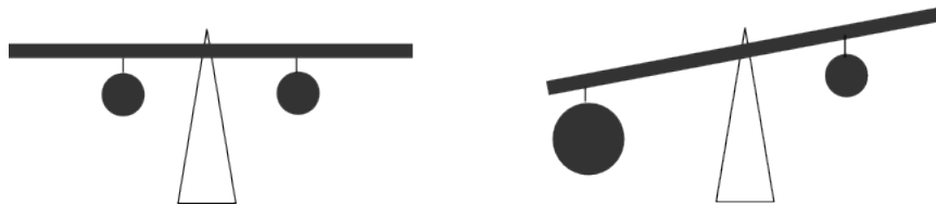
Abbildung 10 Balkenwaage (links: im Gleichgewicht; rechts: Gleichgewicht wird durch schwereres Gewicht in größerem Abstand gestört)
