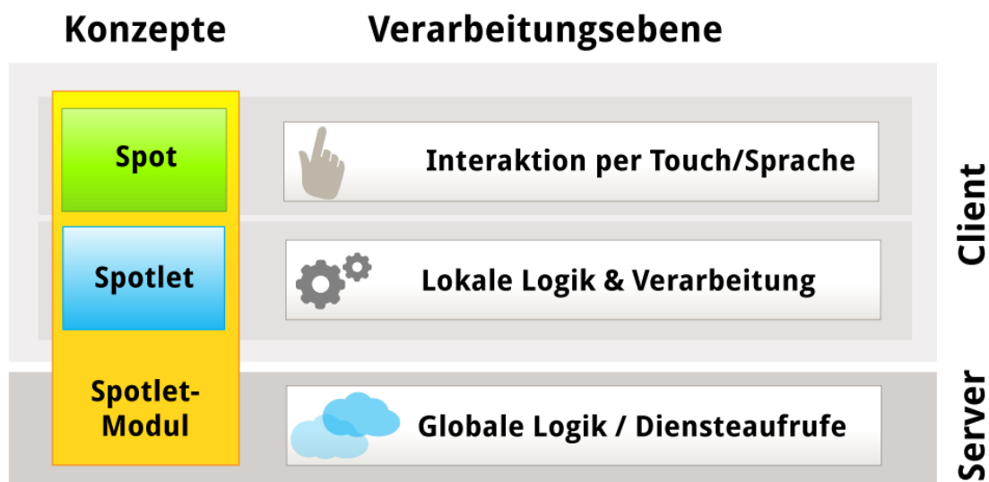
Abbildung 5.11: Prinzip und Verarbeitungsebenen eines Spotlets
