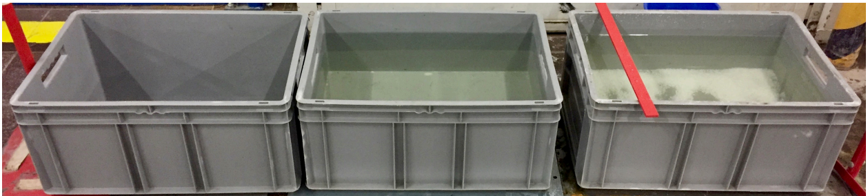
Abbildung 4-18: Versuchsaufbau zur Simulation von drei Grenzfällen: Box mit Luft (links), Box mit Leitungswasser (Mitte), Box mit Salzlösung (rechts).
