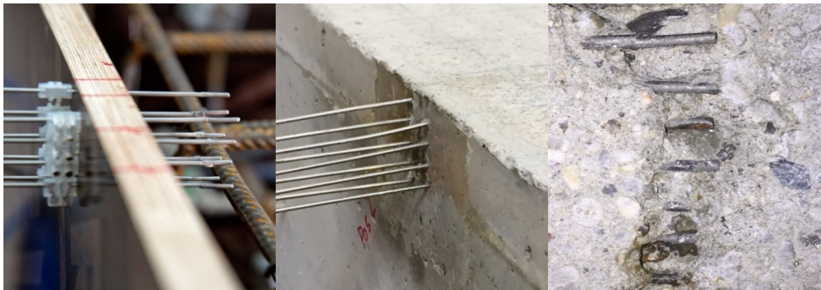
Abbildung 4-3: Depassivierungssensoren mit einer Tiefenauflösung von fünf Millimetern in zwei Reihen; Links: Einbau vor der Betonage; Mitte: Sensoren im Probekörper nach der Betonage; Rechts: Korrodierte Sensorspitzen nach Abschluss der Chloridpenetration.
