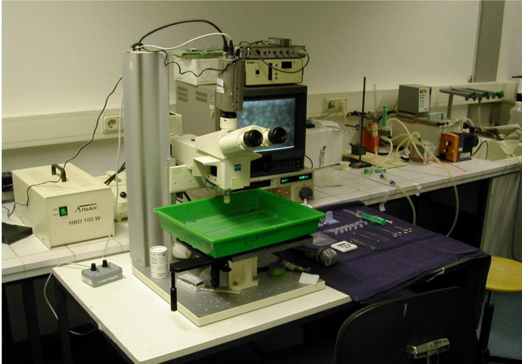
*Abb. 6 Ex situ Modell der Reperfusion: Auflichtfluoreszenzmikroskop mit Kamera und Videosystem zur Aufzeichnung der auflichtmikroskopischen Bilder; rechts oben im Bild Pumpe mit Wärmetauscher und Luftfalle für die Krebs-Henseleit-Reperfusion*
