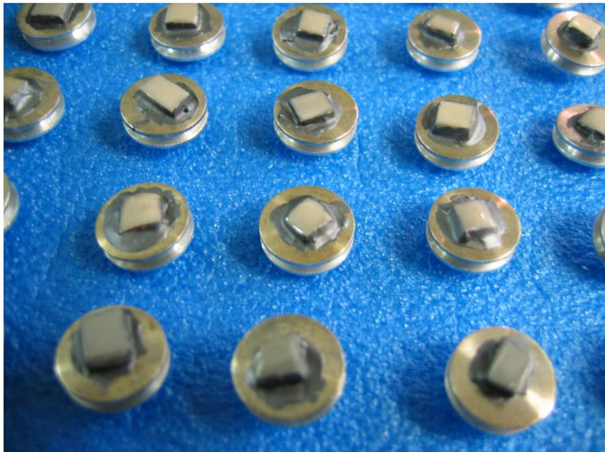
**Abb. 6:** Auf Probentellern fixierte und goldbedampfte („besputterte“) Prüfkörper
