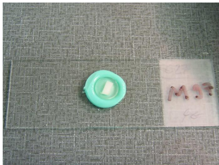
**Abb. 5: In Epoxydharz scheibenförmig eingebetteter und planparallel auf Objektträger fixierter Zahnschmelzprüfkörper**
