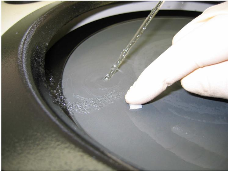
**Abb. 1: Politur der Zahnschmelzprüfkörper auf dem rotierenden Nassschleifgerät unter Wasserkühlung**
