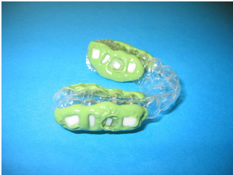
**Abb. 2: Fertig bestückte Prüfkörpertrageschiene unmittelbar vor der Inkorporation. Die Zahnschmelzprüfkörper sind in die Abformsilikonmasse eingebettet.**
