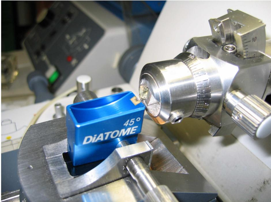
Abb. 7: In das Ultramikrotom eingespannte TEM-Probe während der Ultradünnschnittprozedur
