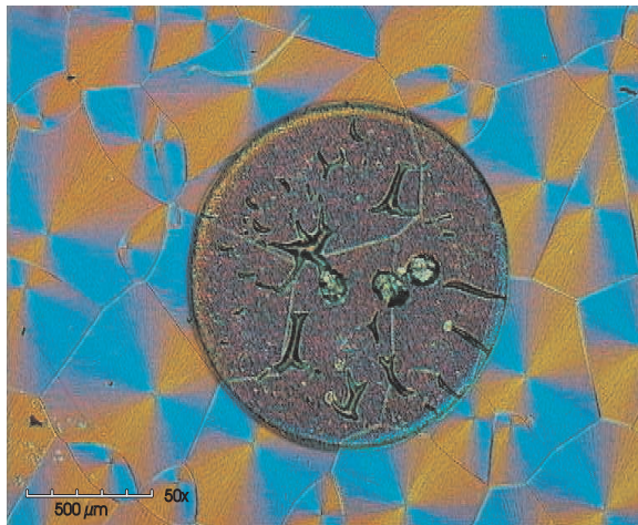
Abbildung 2.2: Mikroskopaufnahme eines PEO Dünnschichtfilms mit aufgedampfter Al-Elektrode
