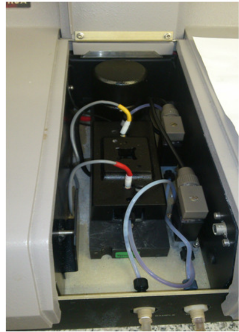
Abbildung 8.7: links: Bild des verwendeten Zetasizers; rechts: graphische Darstellung der Messzelle mit den Durchflusselektroden.
