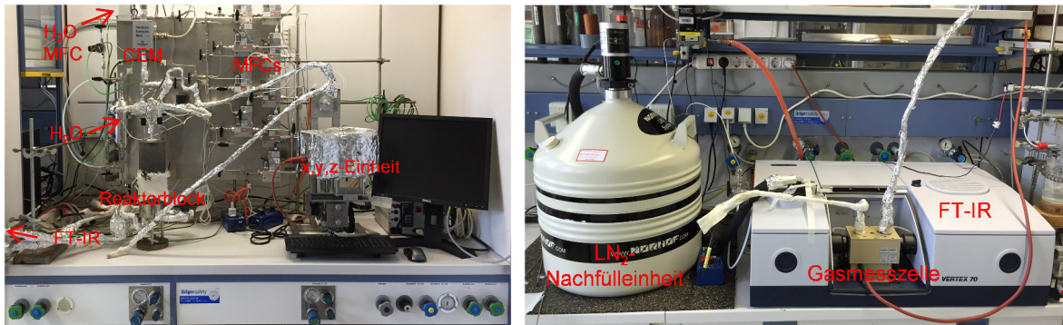
Abbildung 32: Lichtbild des Realaufbaus der Gesamtanlage ohne Gasversorgung (links) und der FT-IR-Analytik mit LN 2 -Nachfülleinheit (rechts).
