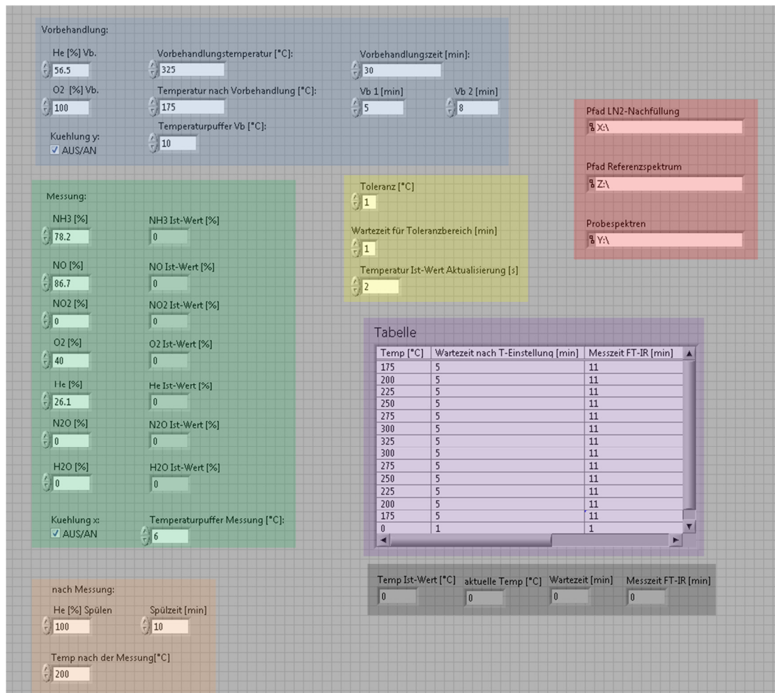
Abbildung 51: Benutzeroberfläche des LabVIEW-Programms „MessungV021“ zur Automatisierung der katalytischen Messung im Strömungsrohr; spezielle Bereiche sind farbig gekennzeichnet (Erläuterung siehe Text). [447]
