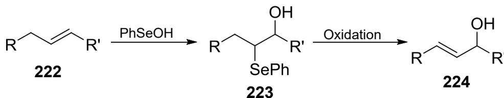
**Abb. 6.23** mögliche Nebenreaktion bei der Regeneration der Doppelbindung<sup>[189]</sup>
