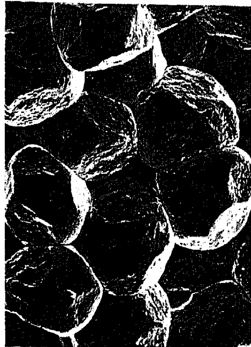
Fig. 4a und b. REM-Stereobildpaar eines Bronzeprässlings (Preßdruck 1 GPa, 1 Stunde vorgesintert), Kippwinkel 10°. Ursprüngliche Kontaktpunkte durch Sinterhalse markiert
