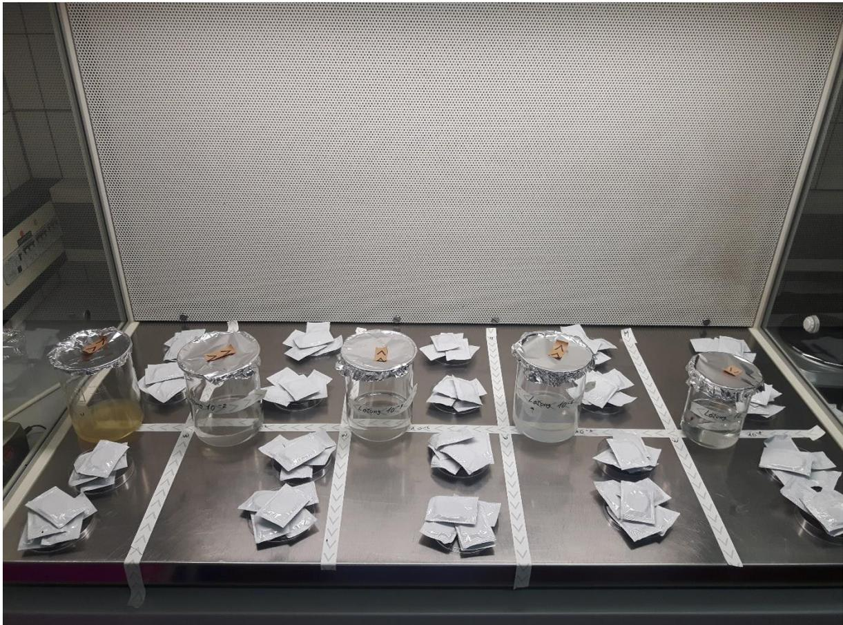
Abbildung 6 Experimentell kontaminierte einzelverpackte Schutzhüllen in der Sterilbank. Pro Verdünnung wurden jeweils 10 mit Milch und 10 mit Ringer-Lösung benetzte einzeln verpackte Schutzhüllen kontaminiert.
