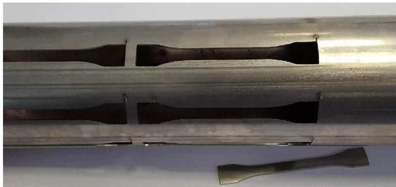
Abbildung 2.17: Lasergeschnittene Zugproben aus dem schweißnahtfreien Abschnitt des Rohres
