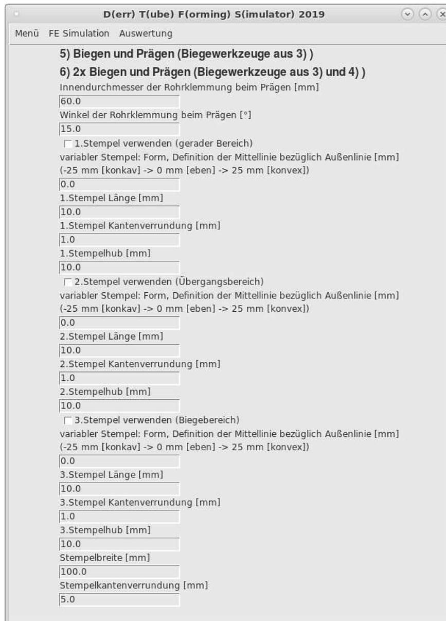
Abbildung 4.28: Einstellmöglichkeiten für den Prägeprozess gebogener Rohre und die dazugehörigen Standardwerte in der graphischen Benutzeroberfläche "DTFS"
