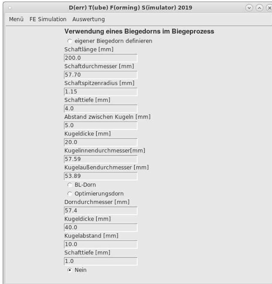
Abbildung 4.26: Einstellmöglichkeiten für den Biegedorn und die dazugehörigen Standardwerte in der graphischen Benutzeroberfläche "DTFS"
