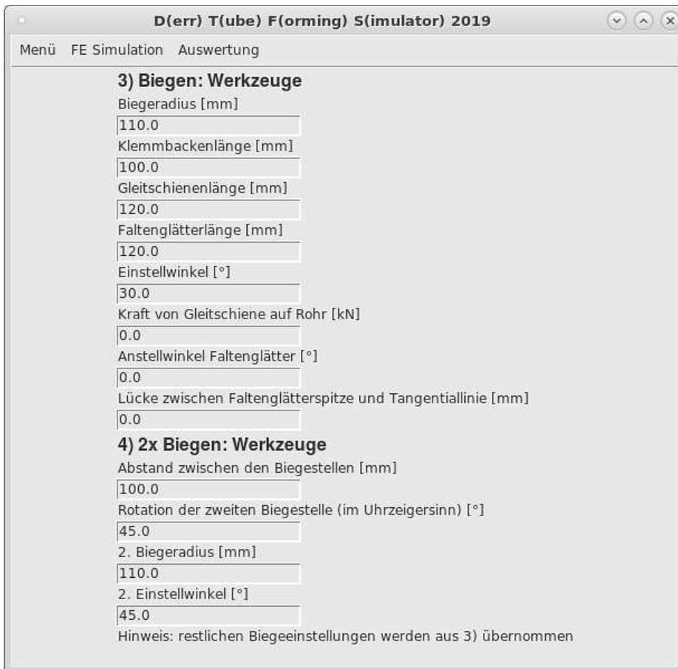
Abbildung 4.13: Einstellmöglichkeiten für den Biegeprozess und die dazugehörigen Standardwerte in der graphischen Benutzeroberfläche "DTFS"
