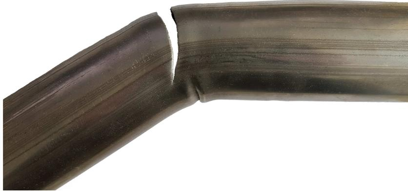
Abbildung 2.9: Riss im Rohrbogen aufgrund falscher Dorneinstellungen
