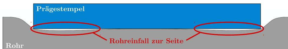
Abbildung 5.2: Prägebereich in Rohrlängsrichtung bei einer Stempellänge von 400 mm
