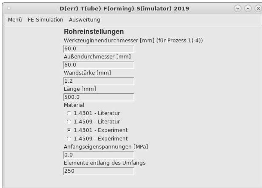
Abbildung 4.3: Einstellparameter zur numerischen Modellierung des Werkstücks in der graphischen Benutzeroberfläche "DTFS"
