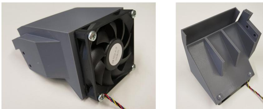
Abbildung 4.28: Lüfter mit Luftstromführung für die Array-Kühlung.
