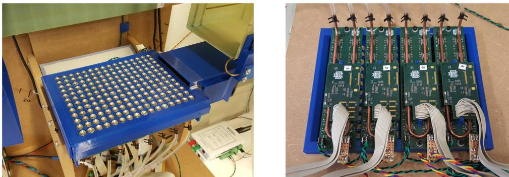
Abbildung 4.24: Einseitiges Array im Windkanal (links). Rückseite des vollbestückten Arrays des einseitigen Aufbaus inkl. Spannungsversorgung und Steuerelektronik pro Treiberplatine und Kühlelementen (rechts).
