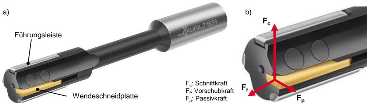
Abbildung 2-3: a) Einschneiden-Reibahle mit Führungsleisten, b) Kräfte an der Wendeschneidplatte (Bildquelle: [WALT20])
