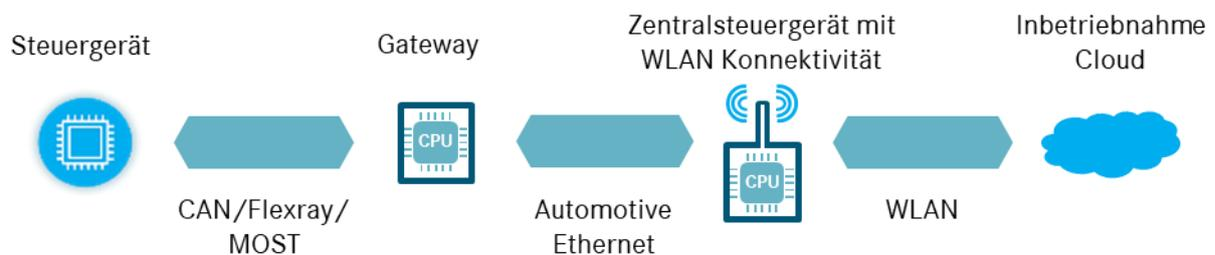
**Abbildung 50:** Vernetzungsteilnehmer zwischen Steuergerät und Inbetriebnahme Cloud
