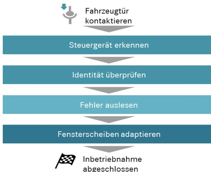
**Abbildung 65:** Inbetriebnahmeschritte bei dem Türsteuergerät
