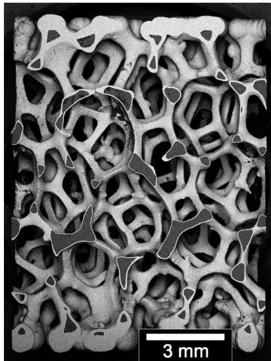
Abbildung 2.4: Inhomogene Beschichtung eine Hybridschaums nach Bouhwuis et al. [21]
