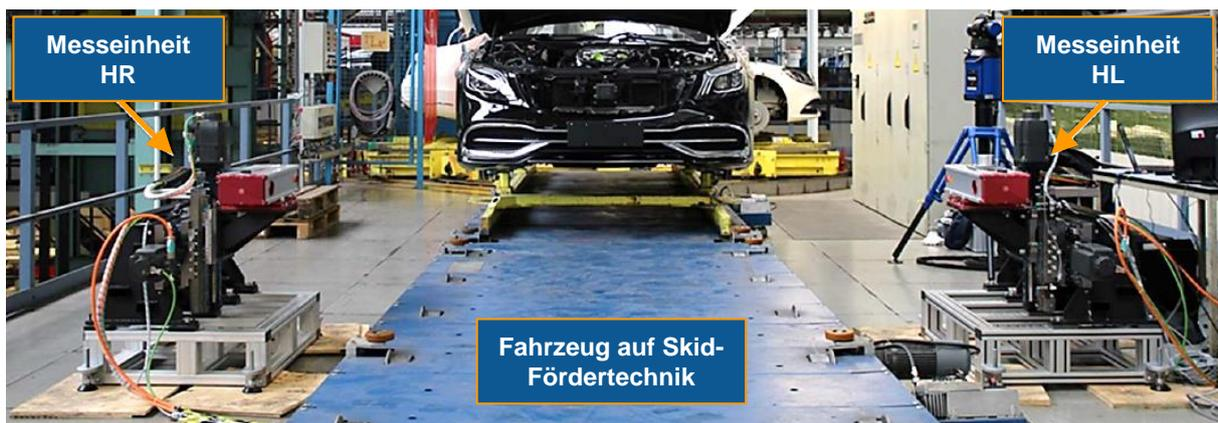
**Abbildung 2.32: Prototyp eines berührungslosen Fahrwerkvermessungsverfahrens in der Montagelinie [JON19]**
