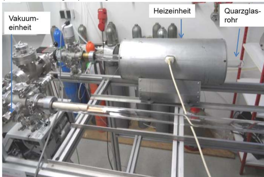
Abbildung 30: Für die Wärmebehandlung verwendeter Vakuumofen
