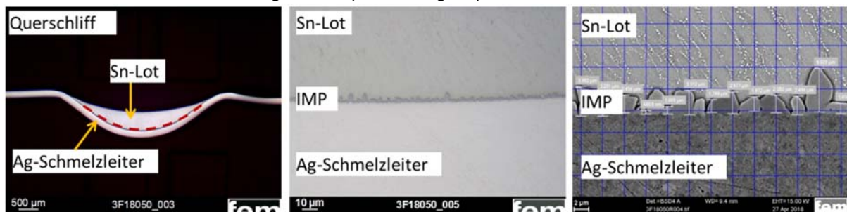
Abbildung 62: Querschliff durch einen beloteten Silberschmelzleiter und Vermessung der IMP-Dicke im REM
