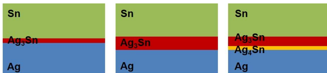
Abbildung 95: Schmelzleiter, links: zum Zeitpunkt der Belotung, Mitte: nach Auslagerung bei 140°C, rechts: nach Auslagerung bei 180°C
