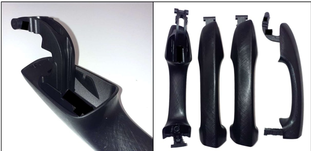
Abbildung 8.14: Vier gleiche Spritzguss Kfz-Türgriffe mit einer Länge von ca. 200 mm; Firmenlogos etc. wurden durch schwarze Rechtecke unkenntlich gemacht. Die Griffe weisen komplizierte Geometrien auf, welche bei einer thermischen Belastung zu komplexen Verformungen führen, vor allem für den Bereich mit rückseitig angebundenem Steg (s. Detailansicht links).
