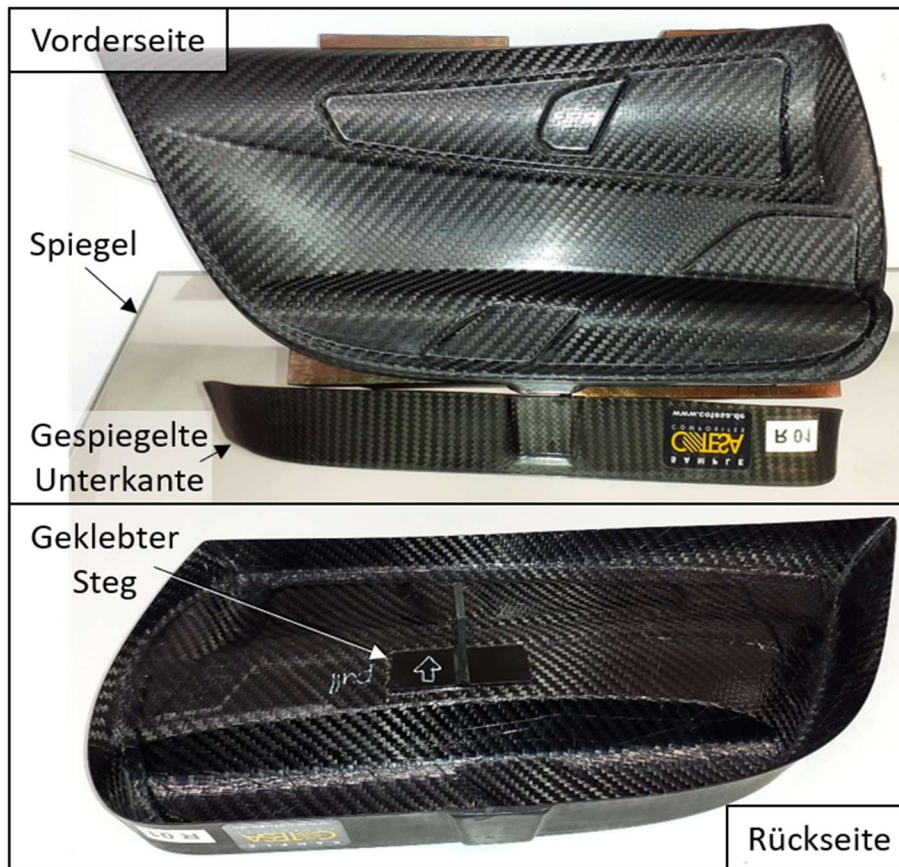
Abbildung 7.2: CFK Bauteil aus Prepreg mit den Kastenmaßen von ca. 300 mm x 150 mm x 30 mm und einer Wandstärke von ca. 0,5 mm, gefertigt von der Firma Cotesa GmbH für den studentischen Wettbewerb im Rahmen des 11. internationalen Symposiums für ZfP in der Luft- und Raumfahrt 2019; das Bauteil ist mit unterschiedlichen Fehlstellen versehen. Die Vorderseite ist glänzend, die Rückseite stark glänzend. Die fehlerstellenbehaftete Unterkante (und linke Kante, nicht dargestellt) wird bei der vorderflächigen shearografischen Prüfung mittels Spiegel in die Prüfrichtung reflektiert.
