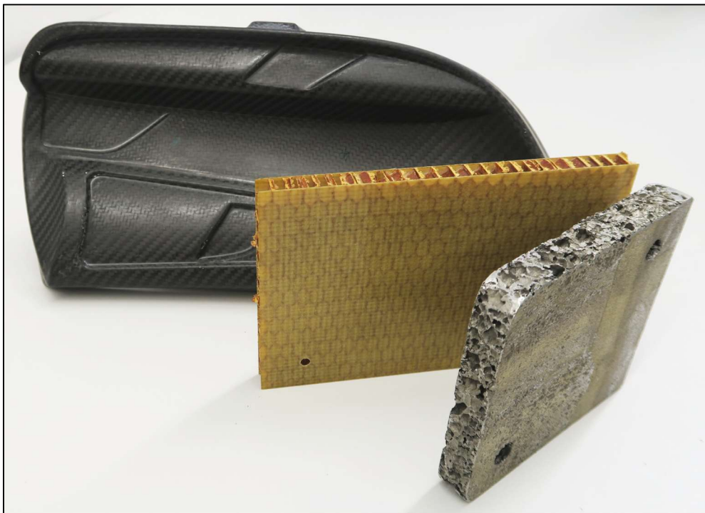
Abbildung 1.1: Moderne Leichtbauteile: dreidimensional geformtes CFK-Bauteil oben links, Sandwichwaben-Bauteil aus harzgetränktem Papier mittig und Aluminium-Bauteil mit geschäumtem Kern.
