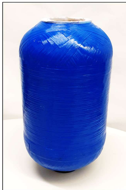
Abbildung 7.16: Mit Glasfaserbündeln umwickelter COPV mit einer Höhe von 340 mm, einem Durchmesser von 190 mm und einem Öffnungsdurchmesser von 70 mm; das Innenteil aus Kunststoff besitzt eine Wandstärke von ca. 10 mm, während die Umwicklungsstärke ca. 5 mm beträgt.
