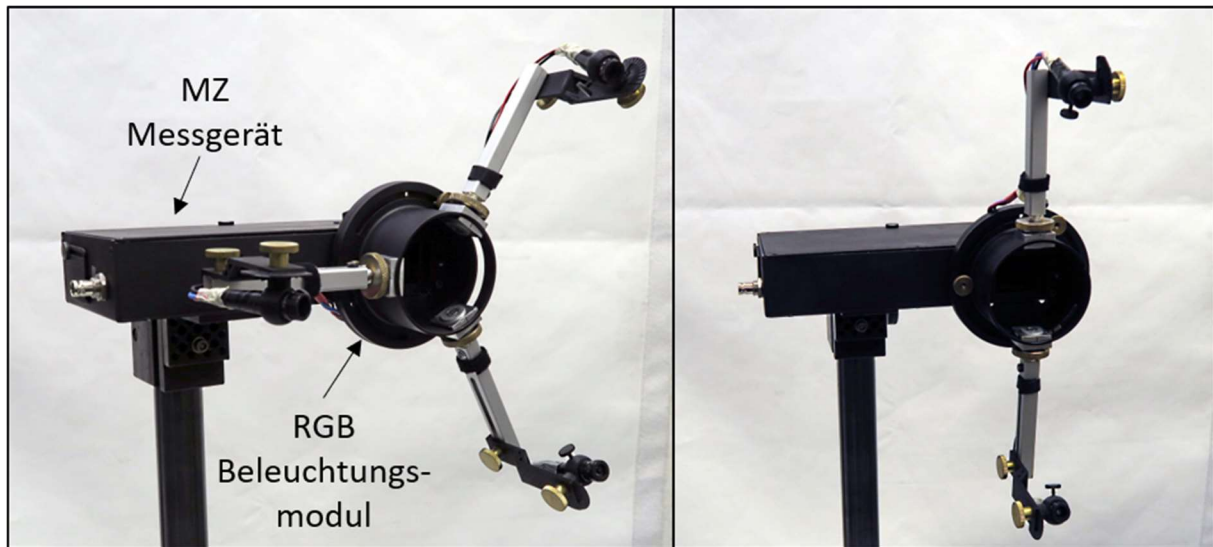
Abbildung 5.7: (Links) angeflanshtes RGB Beleuchtungsmodul am MZ Messgerät mit einer Laserquelle je Beleuchtungsarm in der Konfiguration für die 3 out-of-plane Mechanik; (rechts) rotierte zwei-Arm Konfiguration für eine maximale Sensitivität in vertikaler Richtung (nicht weiter ausgeführt, s. Texthinweis).
