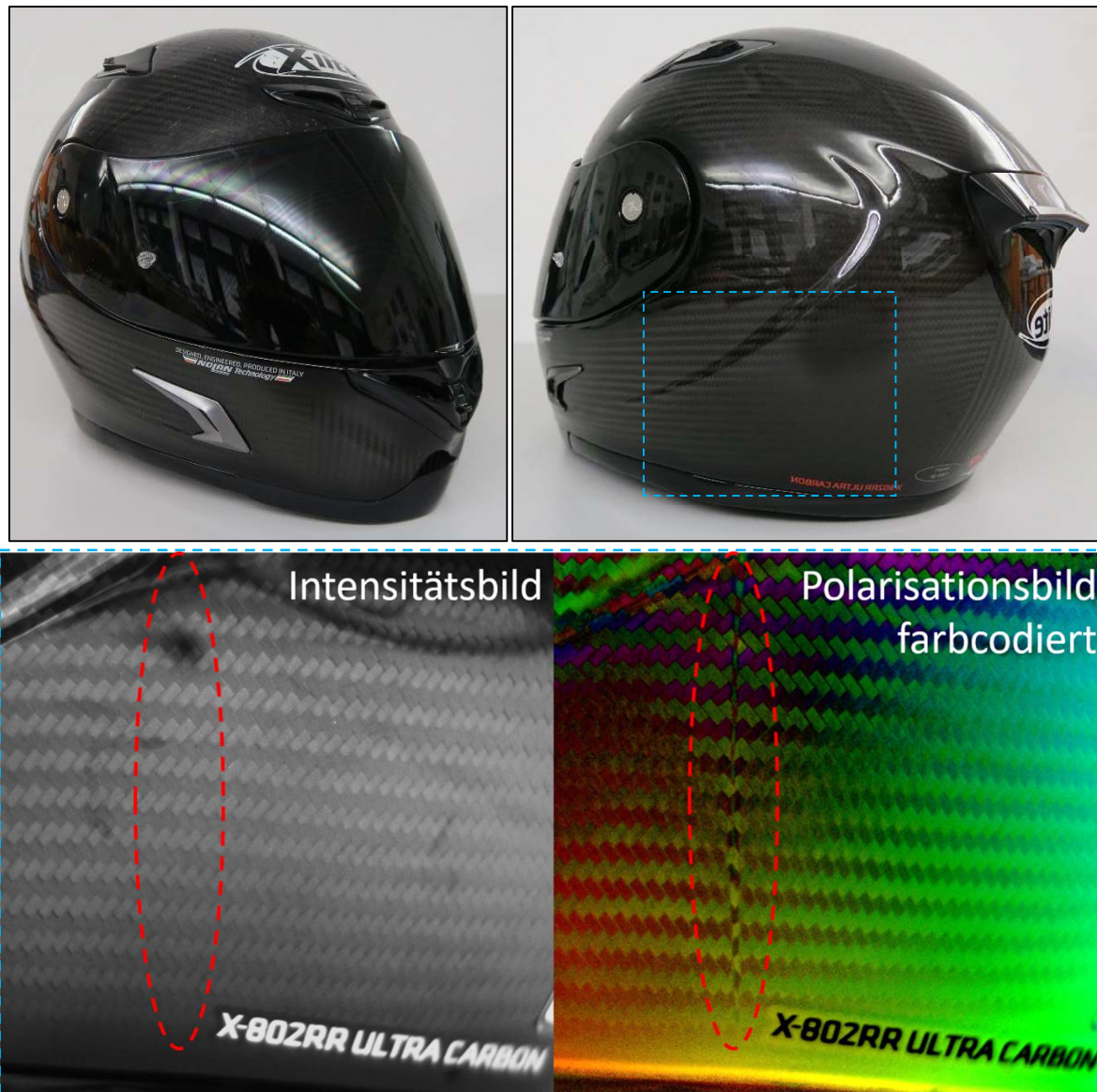
Abbildung 2.16: Motorradhelm aus CFK zeigt seitlich (Bereich blau umrandet) eine Polarisationsanomalie (rot umkreist), welche im reinen Intensitätsbild unsichtbar ist.
