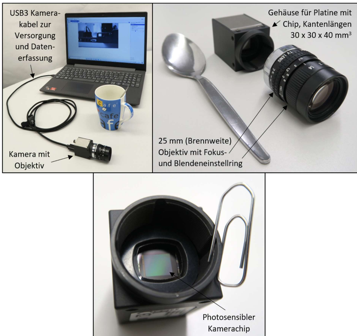
Abbildung 2.13: Industrielles Kamerasystem und seine Komponenten im Größenvergleich zu Kaffeetasse, Kaffeelöffel und Büroklammer.
