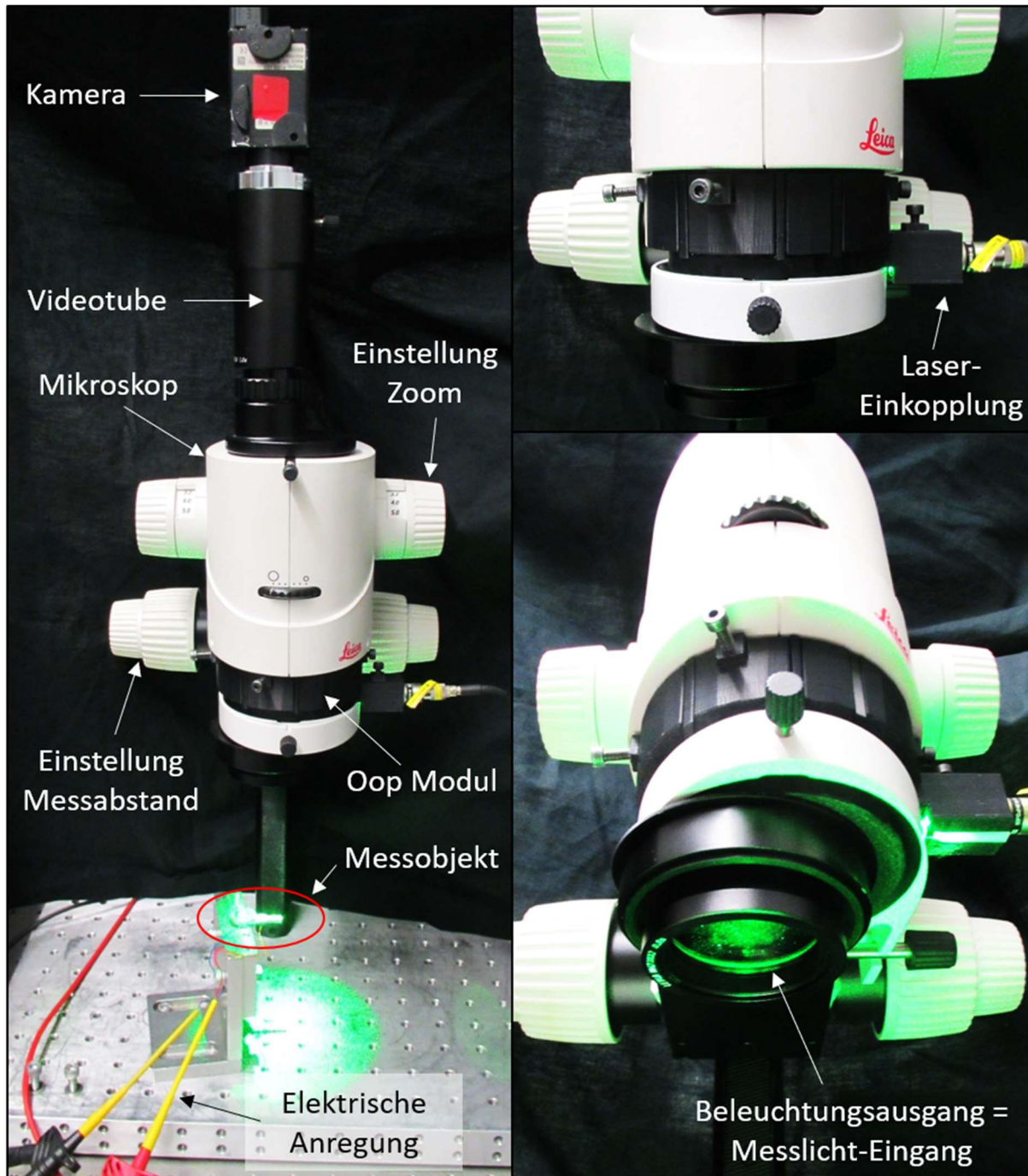
Abbildung 5.13: (links) Mikroferoskop 2 mit oop Modul als Steckeseinsatz in ein handelsübliches Mikroskop; das Modul wurde mittels 3D Kunststoffdruck in Steckbauweise gefertigt und wiegt inkl. der optischen Elemente des Interferometers nur 150 Gramm. (Oben rechts) als Beleuchtungsquelle wird aktuell noch ein externer Laser eingekoppelt. Der Einbau einer Laserdiode mit autarker Versorgung ins Gehäuse des Moduls ist geplant. (Unten rechts) die Laserbeleuchtung des Messobjektes erfolgt koaxial mit der Messobjektbeobachtung, wodurch Schattenbildung vermieden wird.
