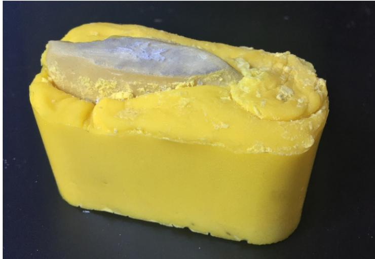
*Abb. 14 Kalibrierungsstempel für Tekscan Messfolie*
