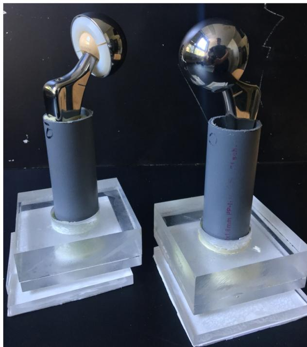
*Abb. 11 Duokopfprothesen in Technovit gegossen auf Plexiglasgleitlager*
