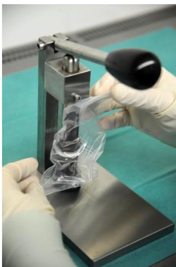
Abbildung 12. Verschluss der Einmalflasche mit Sano-Tropfer mittels einer Verschlussstanze.
