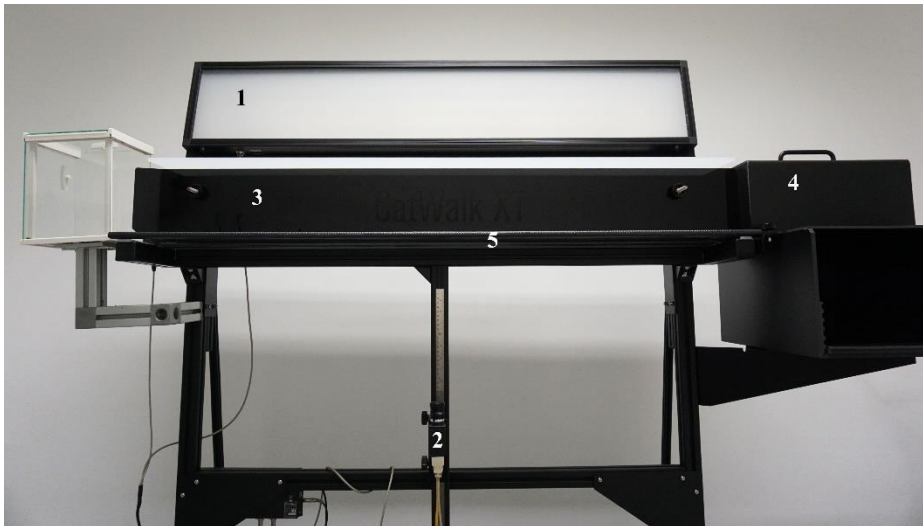
Abbildung 12: Catwalk XT: 1) Top Unit 2) Highspeed-Farbkamera 3) Gefederter Korridor 4) verschlossene Goal Box 5) Glasplatte
