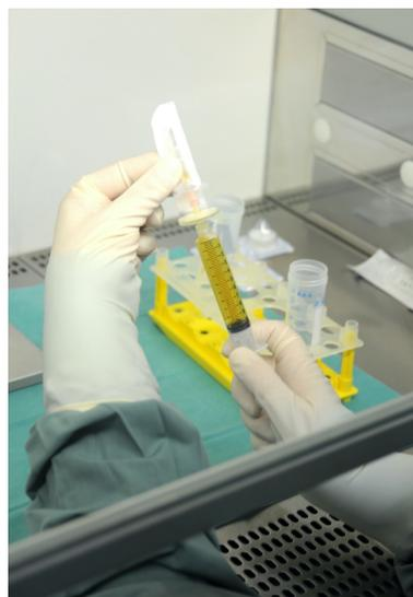
*Abbildung 10: Aufsetzen eines Einmalfilter mit 0,2  $\mu\text{m}$  Porengröße (eigenes Bild)*
