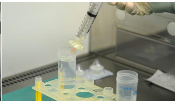
**Abbildung 13:** Durchführung des Bubble-Point-Tests zur Überprüfung des Filters (eigenes Bild)
