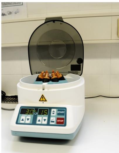
*Abbildung 6: 15-minütige Zentrifugation des Eigenblutes bei 3000 Umdrehungen pro Minute (eigenes Bild)*
