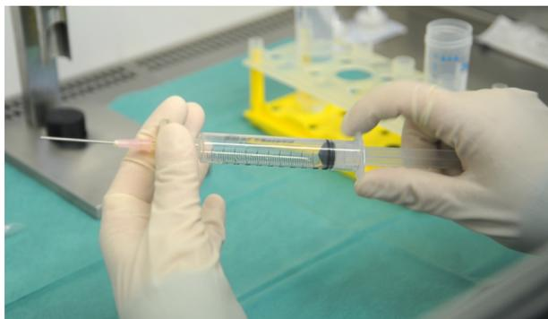
**Abbildung 12:** Vorbereitung der Spritze zum Bubble-Point-Test (eigenes Bild)
