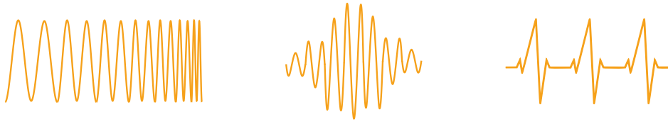
Abbildung 49: Beispiele für unterschiedliche Anregungssignale zum Erzeugen schneller und langsamer, starker und schwacher oder individuell geformter Vibrationen zur Abdeckung unterschiedlicher Anwendungsfälle
