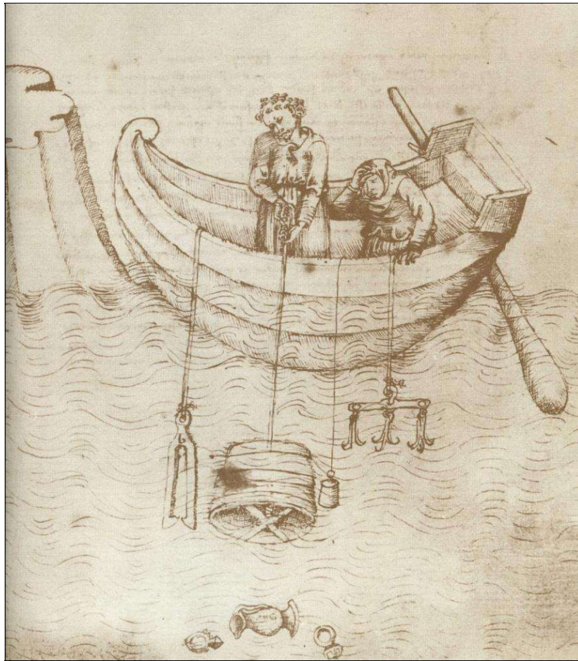
Abbildung 5: Taccolas Unterwasserlampe mit Kerze nach dem Prinzip der Taucherglocke (um 1433). Quelle: Mariano di Jacopo (Taccola), Liber tertius de ingeneis ac edifitiis non usitatis [um 1433] Faksimiledruck des MS. Palat. 766 in der Biblioteca nazionale centrale in Florenz, Hg. James H. Beck, Mailand 1969, fol. 36.
