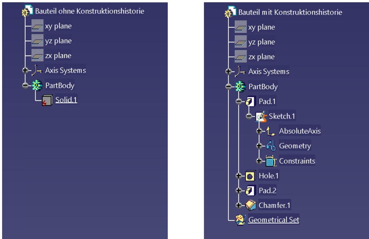
**Bild 3.11:** Vergleich eines CAD-Modells ohne (links) und mit (rechts) Konstruktionshistorie
