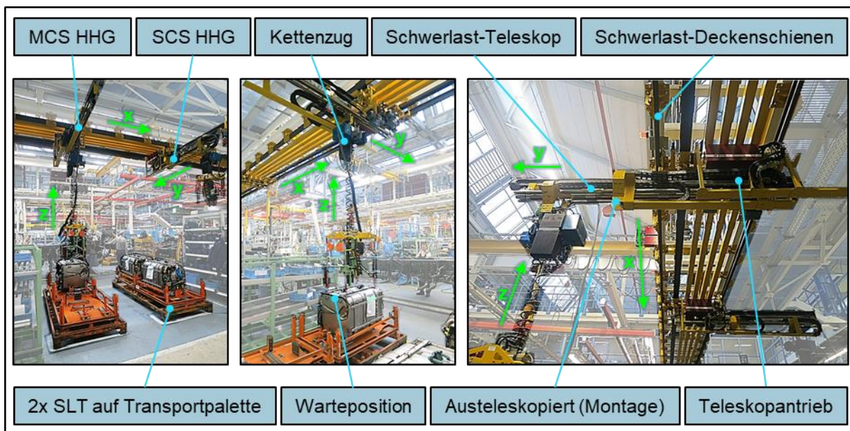
Bild 3.19: Handhabungsgerät ATS-Box Montage; Bildquellen: Daimler Truck
