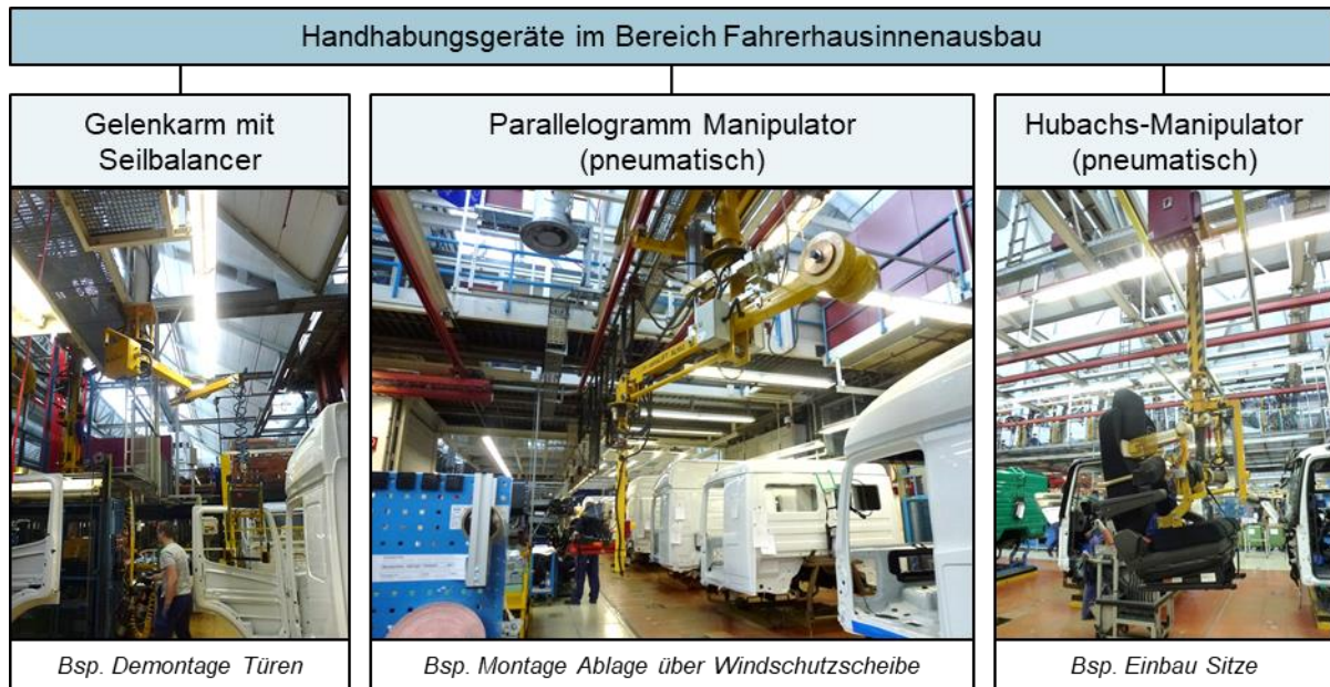
Bild 3.2: Handhabungsgeräte im Bereich Fahrerhausinnenausbau, Bsp. Mercedes-Benz Werk Wörth; Bildquellen: Daimler Truck
