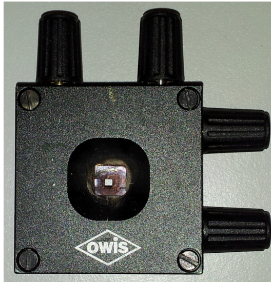
Abbildung C-1: Foto der, für den Hybridaufbau genutzten, Owis Maske. Die vier Plättchen können jeweils separat über die gesamte Öffnung verschoben werden.
