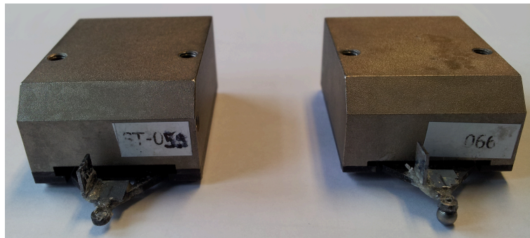
Abbildung A-1: Zwei Kantilever des Nanotribometers der Firma Anton Paar. Die Kugeln werden mit Sekundenkleber befestigt, was zu schwer zu entfernenden Rückständen führt.
