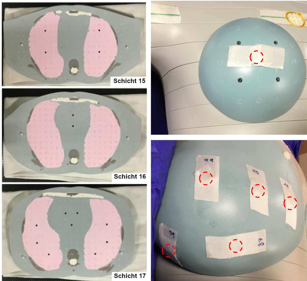
Abbildung 3.9: Verteilung der TLD (Löcher) in den Schichten des Alderson Phantoms. Bei den Brustaufsätzen befinden sich die TLD ca. mittig der eingekreisten Bereiche.
