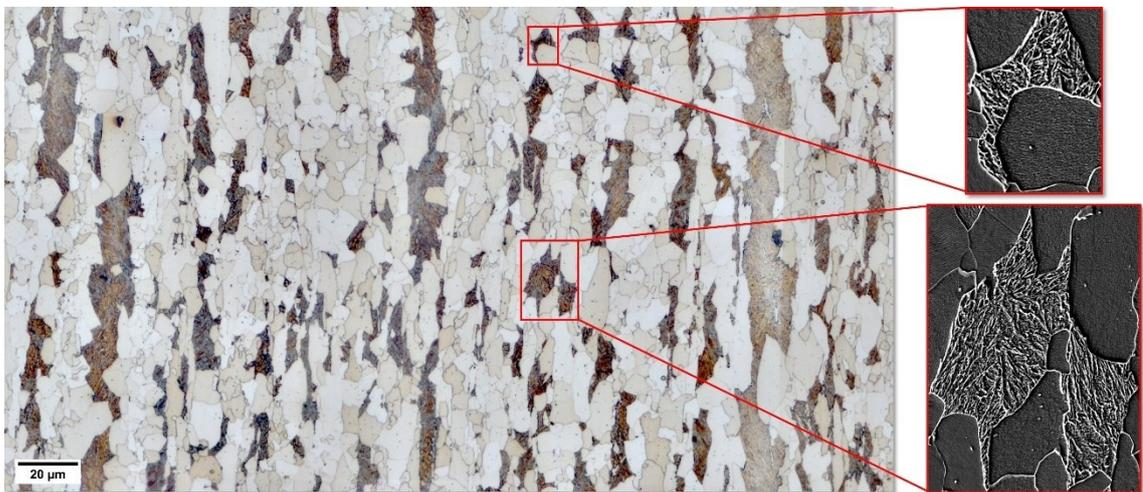
Abbildung 10-5: LM-Aufnahme eines ferrit-bainitischen Zweiphasenstahls mit vergrößerten REM-Aufnahmen einzelner Zweitphase-Objekte.
