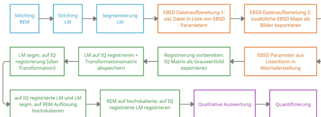
Abbildung 10-7: Auswerte-Workflow der EBSD-Quantifizierung („Variante 2“).
