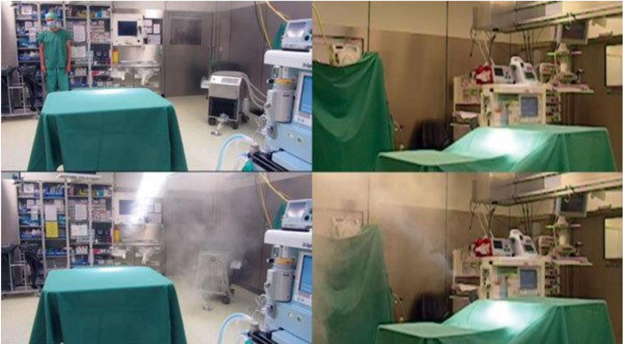
Abbildung 4: Visualisierung des Aerosoleintrages in das OP-Feld (Sommerstein et al. 2016)
