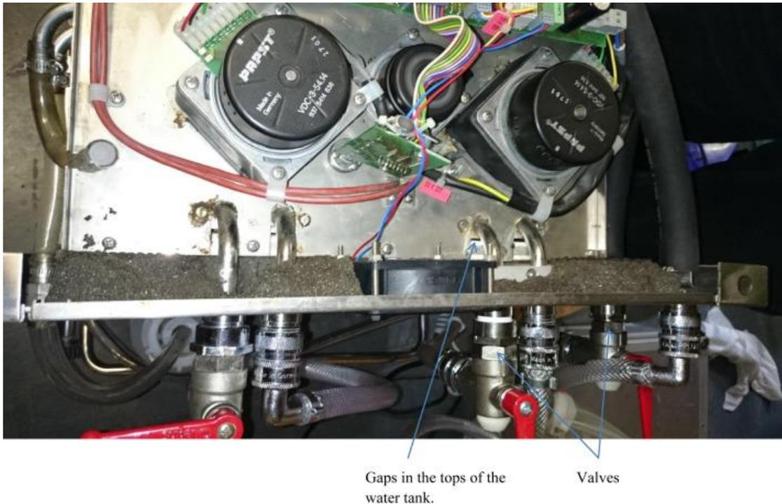
Abbildung 5: Offene HCU mit Sicht auf die Abdeckplatte des Wassertanks. Die blauen Pfeile zeigen auf eine Leckage und die Anschlüsse. (Quelle: Walker et al. 2017a)
