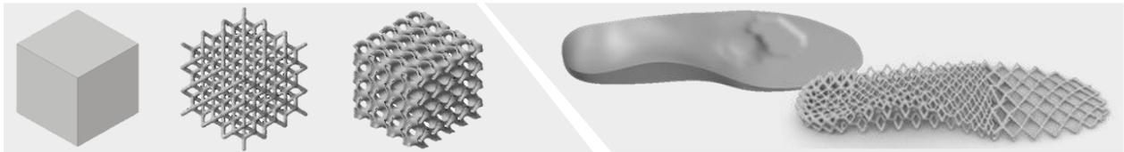
**Abbildung 2: Gitterstrukturen zur Materialeinsparung (Quelle: Labor Industrielle Produktion)**
