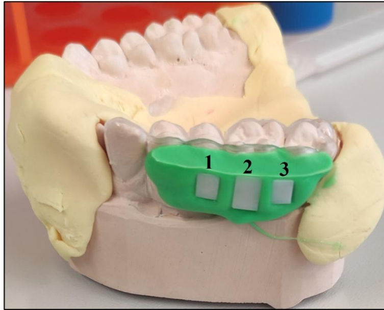
Abb. 1: Rechte Trageschiene auf dem Modell eines Probanden. Die Zahlen 1 bis 3 zeigen die fixierten PK in Silikon. PK 1 und 2 in der Körnung P 2500, PK 3 in der Körnung P 4000.
