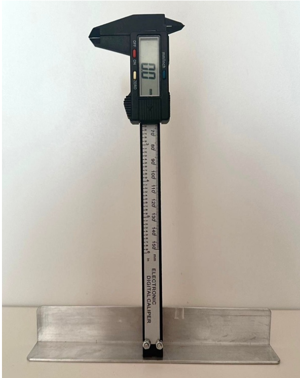
Abbildung 6: Carbon- Messschieber befestigt an einer Aluminiumplatte (20x3cm, 118g)
