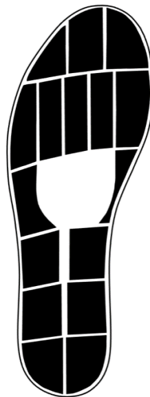
Abbildung 8: Sensoraufteilung der OpenGo Sohlen mit 16 Drucksensoren
