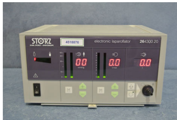
Abbildung 2.1: Automatischer Insufflator der Firma Storz. An einem der Displays kann die verbrauchte CO_2 Menge in Litern einfach abgelesen werden (Foto: P.Schweitzer)
