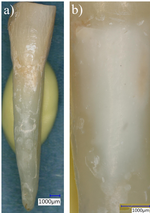
Abb.4.3.20: Digitalmikroskopische Aufnahmen der AAP-Kombination HAP 1 + OptiBond eXTRa Universal mit längerer Konditionierung vor der thermischen Wechselbelastung. a) Präparat vor der Applikation der Paste. b) Applizierte AAP nach der Politur. Glatte und homogene Oberfläche. Optisch guter Verbund. Originalvergrößerungen: 20fach (a), 100fach (b).
