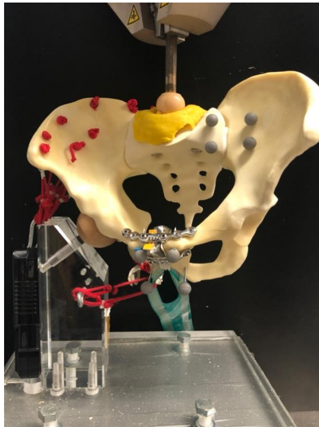
Abb.18- Versuchsaufbau des Einbeinstands mit winkelstabilem Plattensystem und „Bumper“-Platte
