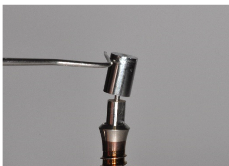
Abb. 13 (links) und 14 (rechts): Zylinderförmiges NiTi-Attachment in einem Straumann-Implantat während und nach Einwirken einer horizontalen Kraft, die hier mittels zahnärztlicher Sonde erfolgte.
