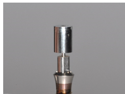
Abb. 13 (links) und 14 (rechts): Zylinderförmiges NiTi-Attachment in einem Straumann-Implantat während und nach Einwirken einer horizontalen Kraft, die hier mittels zahnärztlicher Sonde erfolgte.
