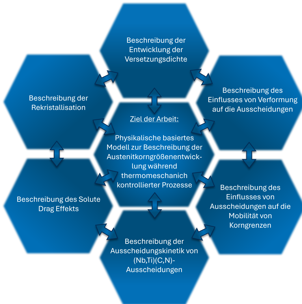
Abb. 3.1: Schematische Darstellung einiger Effekte und deren Wechselwirkungen wie sie sowohl in der Realität beobachtet werden als auch in der Simulation berücksichtigt werden
