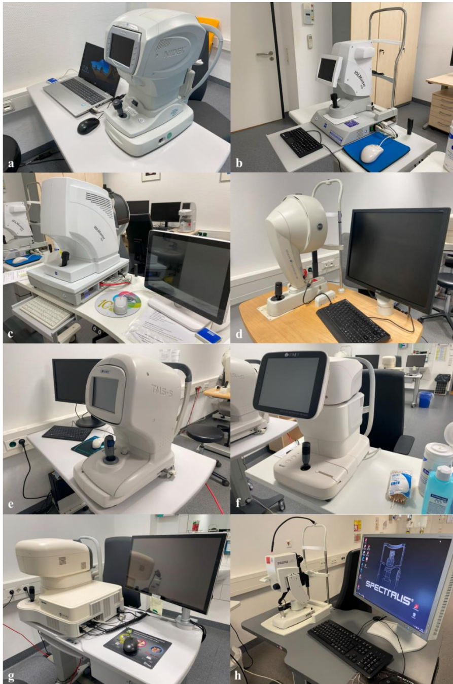
Abbildung 7: Übersicht der für die Datenerhebung verwendeten Untersuchungsgeräte: a: Autorefraktometer NIDEK AR-1 (Tomey Corp., Nagoya, Japan); b: IOL-Master 500 (ältere Generation); c: IOL-Master 700 (neuere Generation, Zeiss Meditec, Oberkochen, Deutschland); d: Pentacam HR (Oculus Optikgeräte, Wetzlar, Deutschland); e: Topographic Modeling System – 5 (Tomey Corp., Nagoya, Japan); f: Endotheliales Spiegelmikroskop EM-4000 (Tomey Corp., Nagoya, Japan); g: Optischer Kohärenztomograph des vorderen Augenabschnittes CASIA2 (Tomey Corp., Nagoya, Japan); h: Optischer Kohärenztomograph der Makula (Spectralis-OCT, Heidelberg Engineering, Heidelberg, Deutschland).
