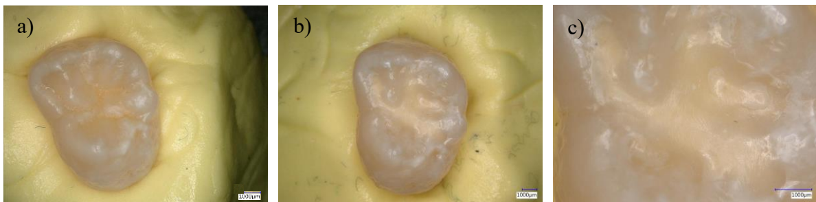
Abb. 4.6: Mikroskopische Aufnahme, HAP 2 + Clearfil Universal Bond Quick (10 mg : 30 mg), a) Übersicht ohne Material, b) Übersicht mit polierter Fissurenversiegelung, c) Ausschnittvergrößerung der polierten Fissurenversiegelung. Originalvergrößerungen: a) 20x, b) 20x, c) 50x.
