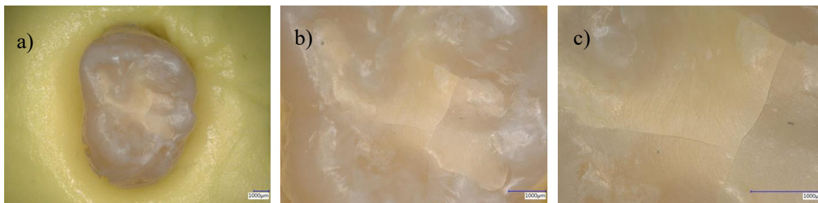
Abb. 4.9: Mikroskopische Aufnahme, HAP 2 + Clearfil Universal Bond Quick (10 mg : 30 mg) nach dem Thermocycling, Originalvergrößerungen: a) 20x, b) 50x, c) dreidimensionale Aufnahme 100x.
