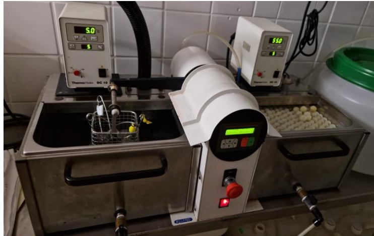
Abb. 3.1: Willeytec Thermocycler V 2.8, SD Mechatronik GmbH. Das linke Becken ist das Kaltbad (5 °C) und das rechte das Warmbad (55 °C).
